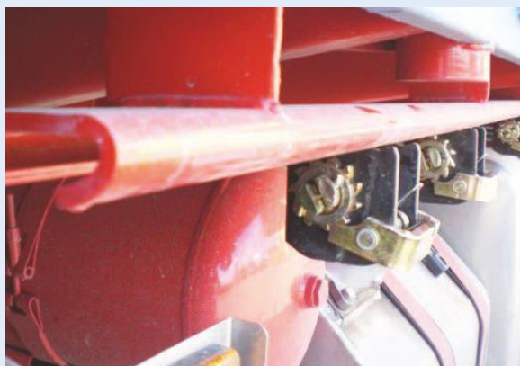
Лебёдка Omega (SIV25000 стр. 21) и направляющая Omega образуют надёжную систему крепления.
