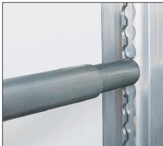
Промежуточные балки TD также выполняют функции крепления и разделения грузов.
