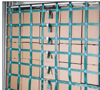
Вертикальные направляющие TD подходят для крепления грузов в горизонтальном направлении.
