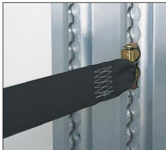
Промежуточные балки TD также выполняют функции крепления и разделения грузов.
