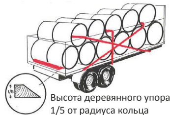
Крепление бетонных колец
