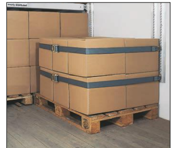
Вертикальные направляющие TD подходят для крепления грузов в горизонтальном направлении.
